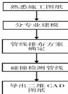
图1 建模出图流程
