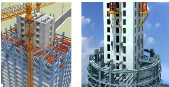
图4 钢框架—核心筒结构体系
