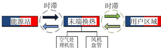
图1 中央空调的运行流程
